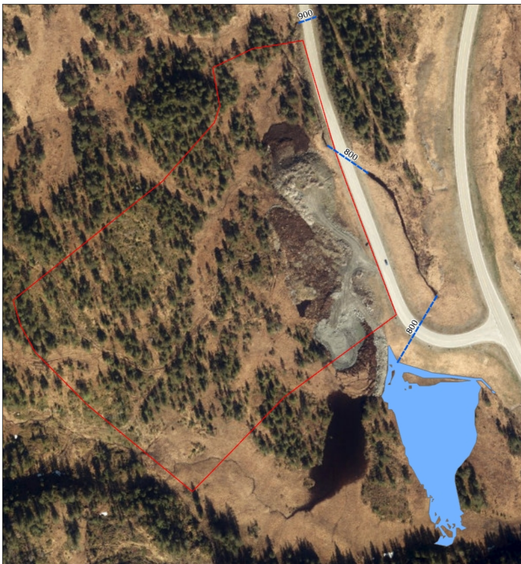
Figur 5-2: Kartet viser resultater fra «depression map»-analyse i programvaren Scalgo. Blått område viser utstrekningen på et tilført vannvolum på ca. 350 m 3 , forutsatt at vannet ikke renner videre gjennom kulverten.
