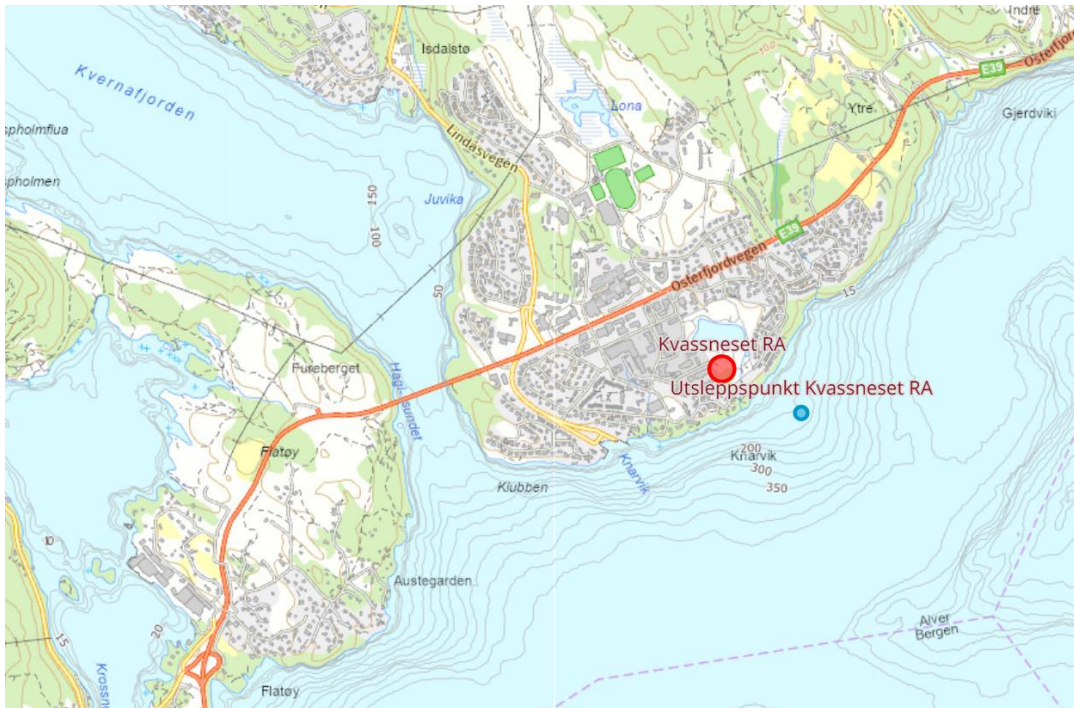
Figur 1: Kartutsnitt frå Fylkesatlas.no. Planlagt plassering av reinseanlegget er vist med raud sirkel, og omtrentleg plassering av utsléppspunktet med blå sirkel. Utsléppspunktet er planlagt på om lag 60 meters djupne og 200 meter frå land.
