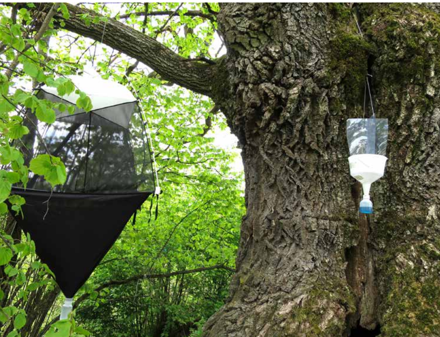
En god kartlegging av artsmangfoldet tilknyttet hule eiker krever bruk av ulike insektfeller. Her illustrert med et malaisetelt og en vindusfelle på en grov, hul eik i Lier kommune. Foto: Stefan Olberg.
