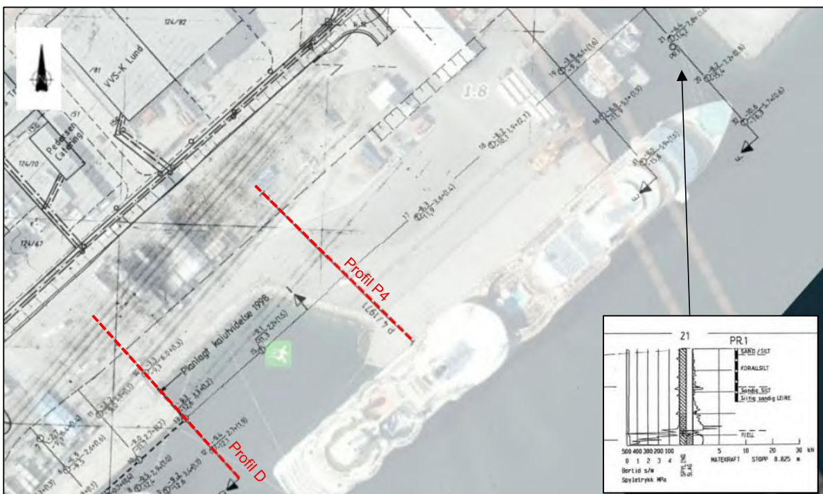
Figur 2-1: Borplan med flyfoto i bakgrunn (alle kotehøyder i sjøkartnull/ LAT, dvs. 1,69 meter under NN1954)
