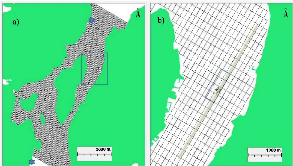
Figur 3. Modellgitter. a) Hele modellområdet. Firkanten markerer området som er vist i detalj i b) og stjernene viser posisjonene til utplasserte vannstandsmålere. b) Utslippsområdet. Stjerne markerer posisjonen for dumping av enkeltlass. Firkanten markerer det totale utslippsområdet. Linjen viser posisjonen til snittene i Figur 7 - Figur 10.
