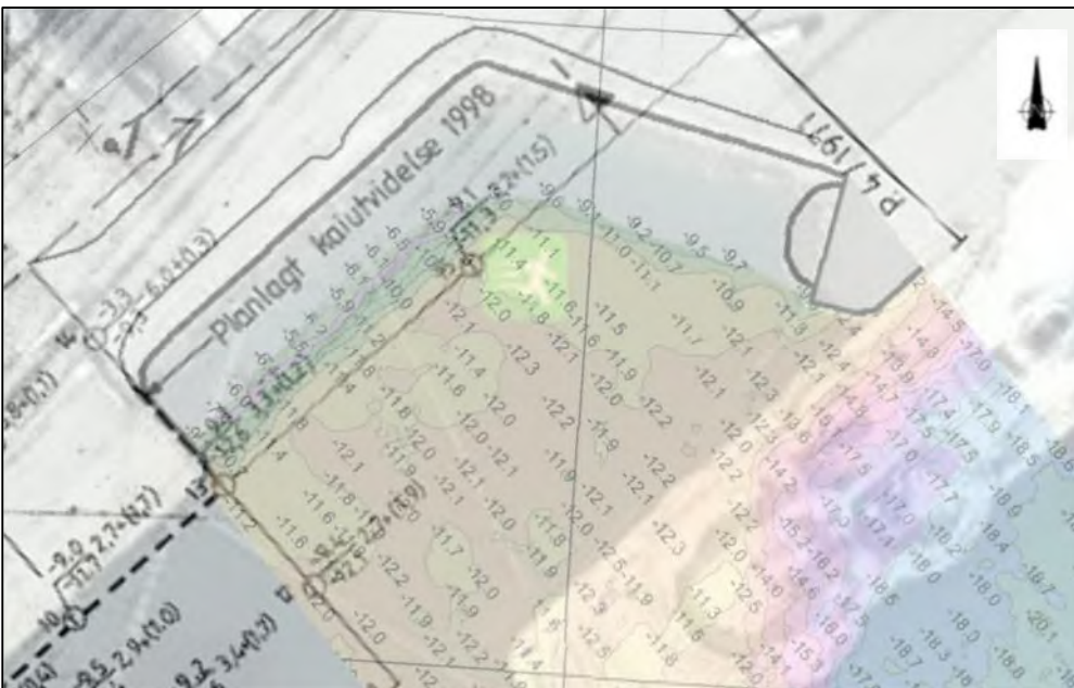
Figur 3-2: Vanndybder i sjøområdet ved kaia, boringer i sjøkartnull, kart i NN1954 (Mottatt fra Tromsø Havn 2021-01-12), dato på innmåling er ukjent, men fil-format indikerer innmåling fra nyere dato, stipulert 2010 ifb. utdypning ved Kai 25.
