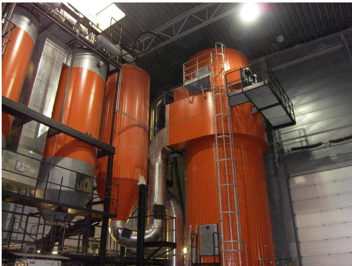
Figur 6-3: Posefilter. Ved å henge opp kjetting unngår man å trække feil, og falle ned gjennom leder.
