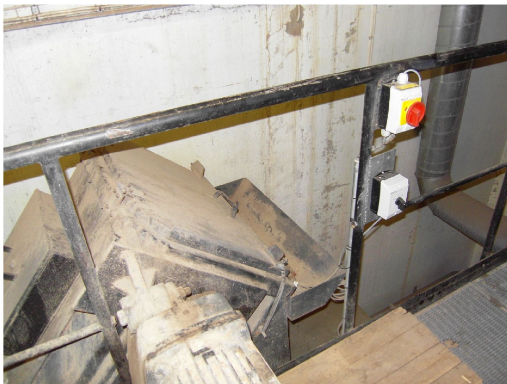
Figur 6-2: Her bør det bygges et lite repo. Det er høyt ned her.
