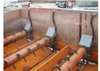
Tildekking med leire i Oslo havn. Bildet viser tromler for oppmaling av leire i fallbunnslekter.
