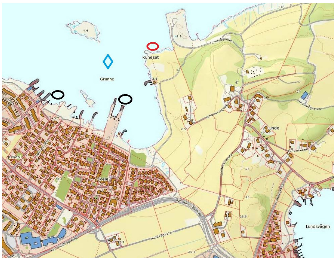
Figur 1. Oversikt over utfyllingsområde med resipient. Rød sirkel = ålegrasforekomst som skal beskyttes med barriere mot partikkelpåvirkning, svarte sirkler = øvrige ålegrasforekomster registrert i 2012, blå firkant = plassering av sedimentfelle.
