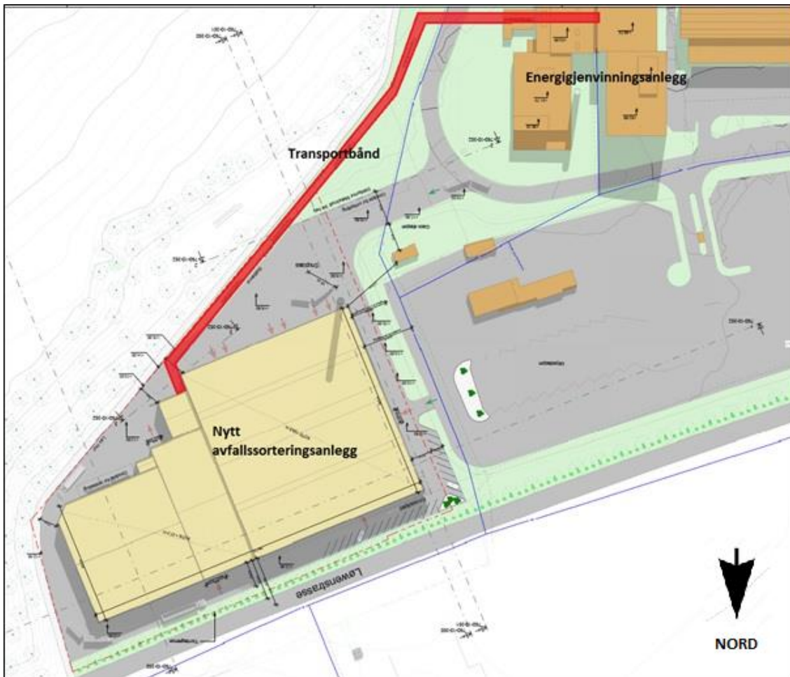
Figur 3-4: Foreløpig plantegning av nytt avfallssorteringsanlegg og transportbånd med forbindelse til energigjennvinningsanlegget. Transportbåndet er markert rødt.
