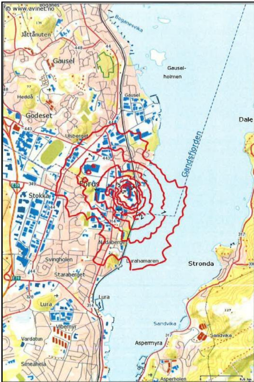
Figur 2 Spredningsdiagram for estimert luktutslipp fra Nortura Forus. Her er det forutsatt 90 % rensing av gjødelskjeller og gammelt rensesanlegg. Verdiene er angitt i \text{ou}_E/\text{m}^3 som timemidler (99-persentiler på månedsbasis).
