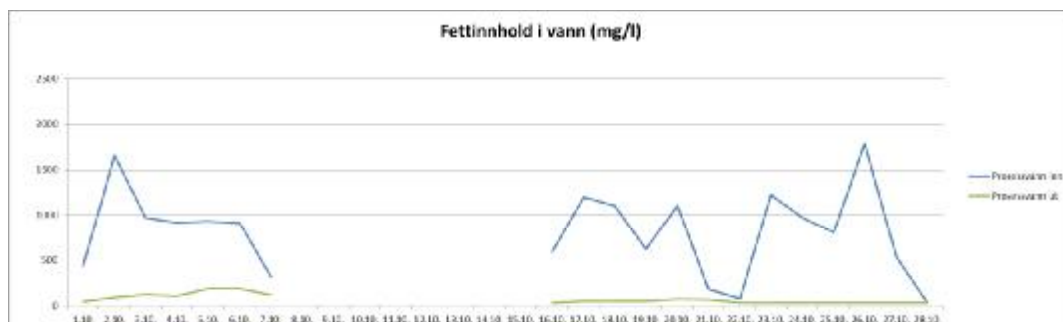
Figur 2 Konsentrasjon av fett i prosessvannet før og etter rensing for 20 døgn i oktober.
