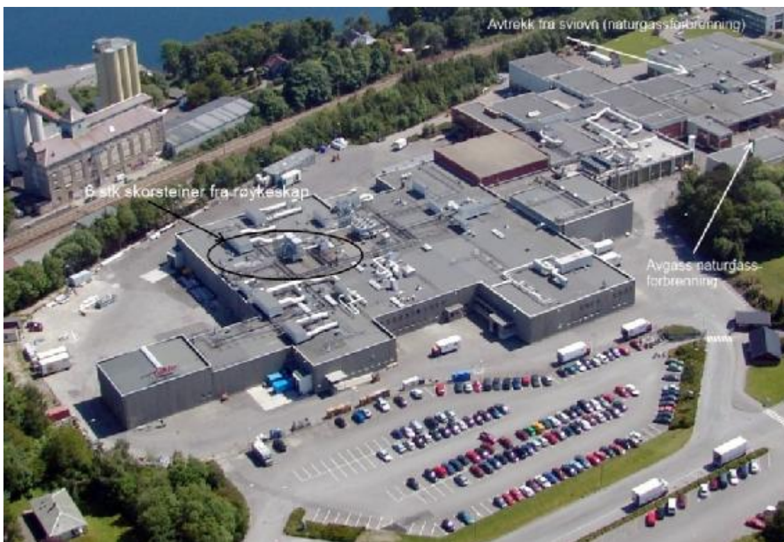
Figur 8 Oversikt over utslippspunkt for koke/røykeprosessen, avtrekk fra sviovn og avgass fra naturgassforbrenning kjel. Tall for CO 2 -utslipp fra sviovn og koke/røykeprosessen (prosessavgasser) er gitt i søknad punkt 5.1. CO 2 -utslipp fra anlegg brukt til energiproduksjon er gitt i punkt 5.5.
