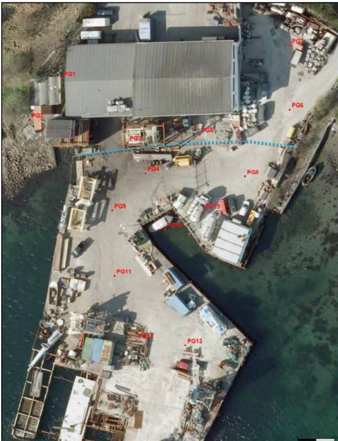
Figur 3: Viser flyfoto av området og prøvegroperne PG 1 til PG 14 (ikke i målestokk). Flyfoto med innmålte prøvegroper er et utsnitt fra vedlegg A til rapport 613921-1. Ca. plassering av opprinnelig strandlinje er vist med blå, stiplet linje.
