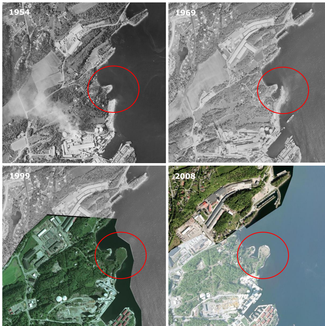
Figur 3. Flyfoto som viser forming og utfylling av Tåjeodden fra 1954 frem til 2008. Fotografier er hentet fra norgebilder.no .
