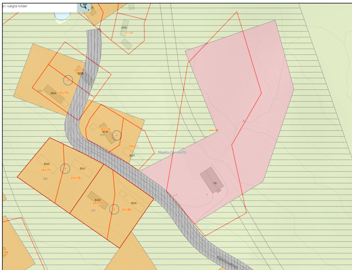
Figur 6: Utdrag fra gjeldende reguleringsplan Nipeto - Gampeflå, areal avsatt til Nipeto renseanlegg. Areal avsatt til avløpsanlegg er markert med rosa farge i eksisterende reguleringsplan. Eiendommen der renseanlegget ligger er markert med rød strek. Eiendomsgrensene skal tilpasses areal regulert til avløpsanlegg ved omregulering av området.
