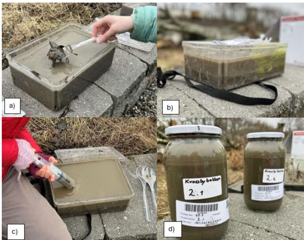
Figur 15 viser rekkefølgen av utført prøvebearbeidelse. a) viser første steg i prøvebearbeidelsen, fjerning av stort materiale fra prøven. b) viser andre steg i prøvebearbeidelsen, henstand av prøvemateriale. c) Viser tredje steg i prøvebearbeidelsen, dekantering av prøve. d) Viser siste steg i prøvebearbeidelsen, fylte prøveglass med merking av prøvestasjon og laboratorie-ID. Fotografier av Krista Quorning.
