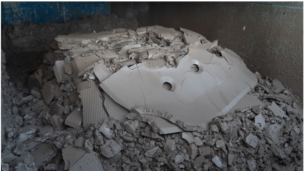
Figur 16 Bilde som viser ferdige filterkaker (finstoffresten fra det opprinnelige tunnelslammet)
