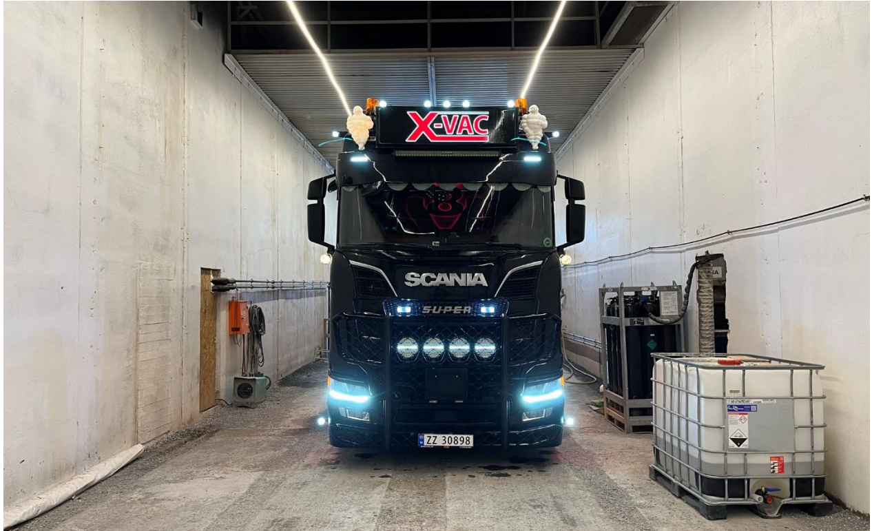
Figur 11 Bildet viser sugebil med slam som har kjørt inn i hallen og er klar for å tømme tunnel slam på anlegget.
