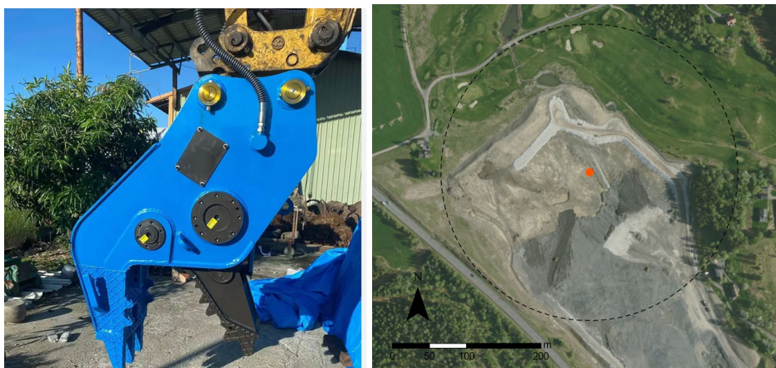
Figur 2 venstre: Hydraulisk enhet som tygger betongen og muliggjør utsortering av armeringsjern. Bildet er fra: weixiang.com. Høyre: Rød prikk markerer hvor i deponiet arbeidet vil foregå. Den sorte stiplede sirkelen markerer 200 m fra plasseringen.
