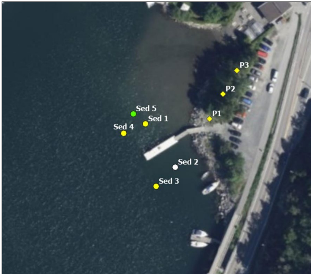
Figur 6 Kartutsnitt som viser hvor sedimentprøvene er tatt. Sed 1-4 er overflateprøver av sedimenter, mens sed 5 er kjerneprøve. Punktene er farget etter forurensningsgrad iht. klassifiseringsgrenser gitt i Veileder M-608/2016. Sed 2 ble borte på laboratoriet og er derfor ikke analysert. P1-P3 er jordprøver tatt ved eksisterende parkeringsplass. Kilde: cloudgis.multiconsult.no
