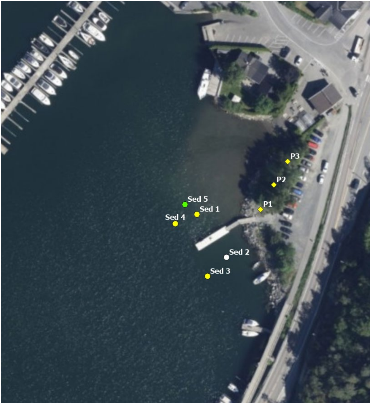
Figur 4-1. Kart som viser forurensningstilstand fargekodet i henhold til tilstandsklassene i Miljødirektoratets veileder TA-2553/2009 og M-608. P1-P3 er prøver tatt av løsmasser på land. Sed1-Sed5 er sedimentprøver.
