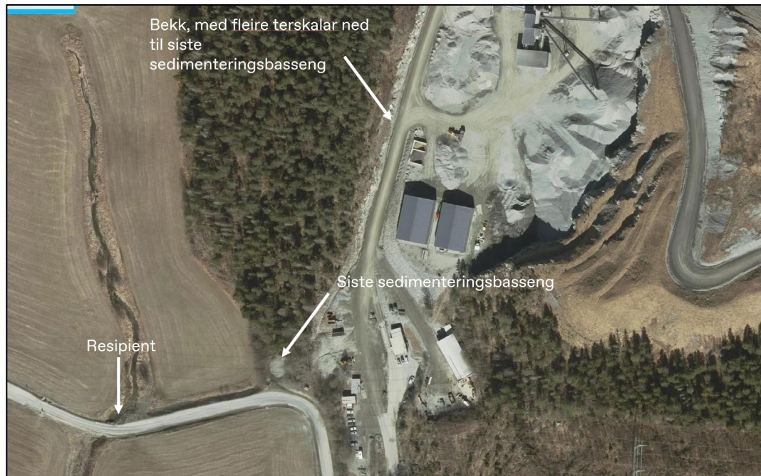
Bilde 1.7 Presentasjon av planlagt håndtering av forurenset smeltevann og masser. Kilde: Roy Nannings (Veidekke AS).
