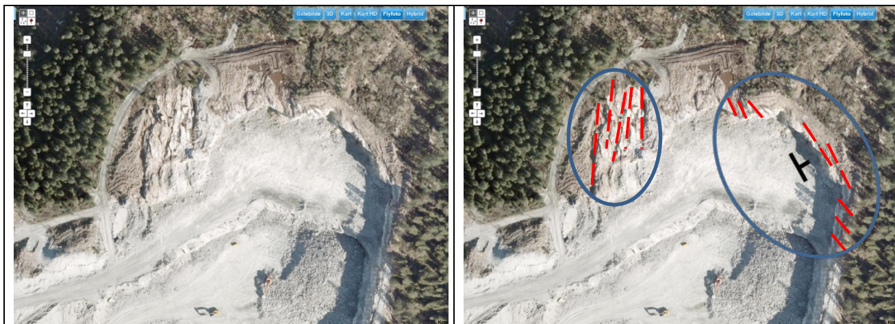
Figur 7 Historiske flyfoto fra finn.no, år 2007 som viser steinbruddets nordligste område. To av hovedsprekkesettene er synlige. Sprekkene i øst har strøk mellom 320\text{--}360^\circ og fall mellom 80\text{--}85^\circ . Sprekkene i vest har et strøk i nord-sydlig retting med steilt fall.
