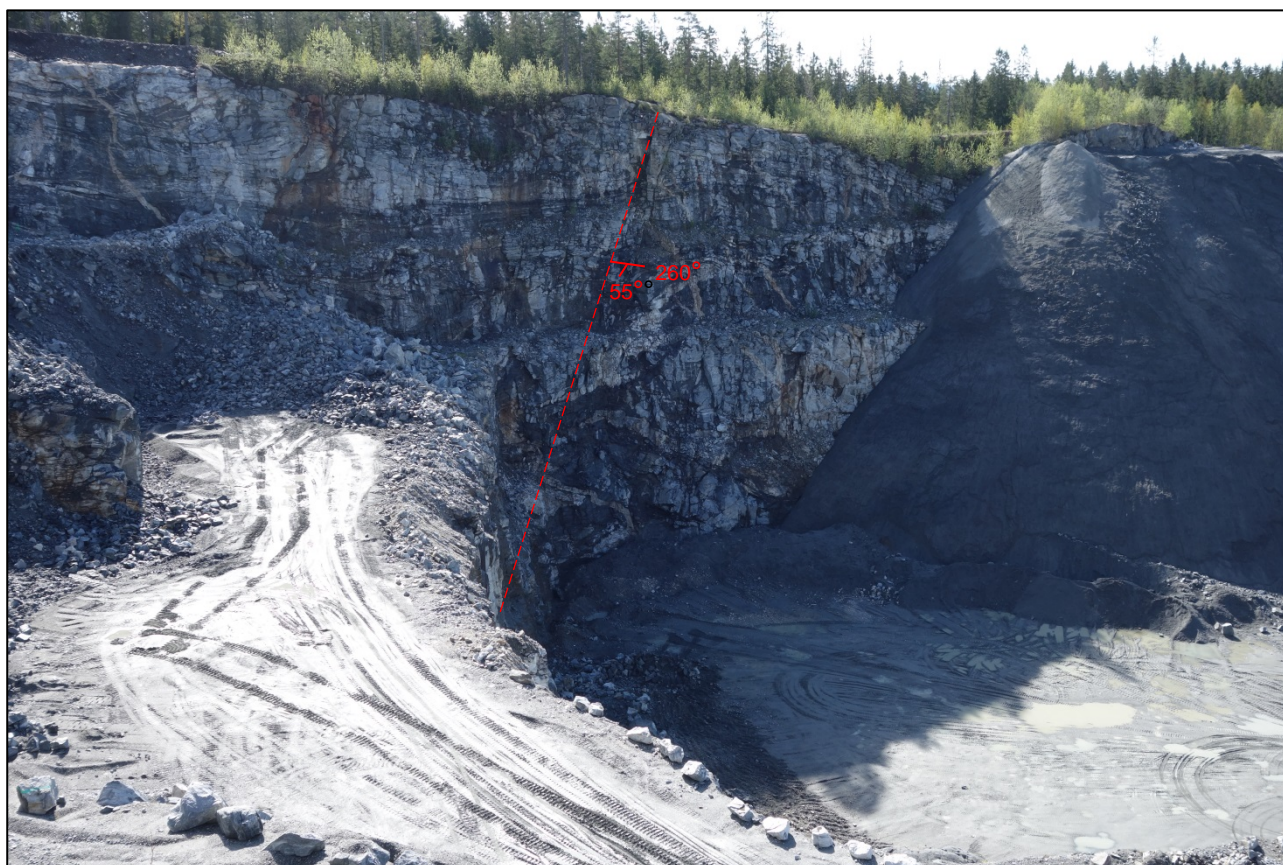
Figur 8 Foto fra steinbruddets nordligste område sett mot øst. Her synes fjellets gneisstruktur som har en foliasjon som er nær horisontal eller med svakt fall.
