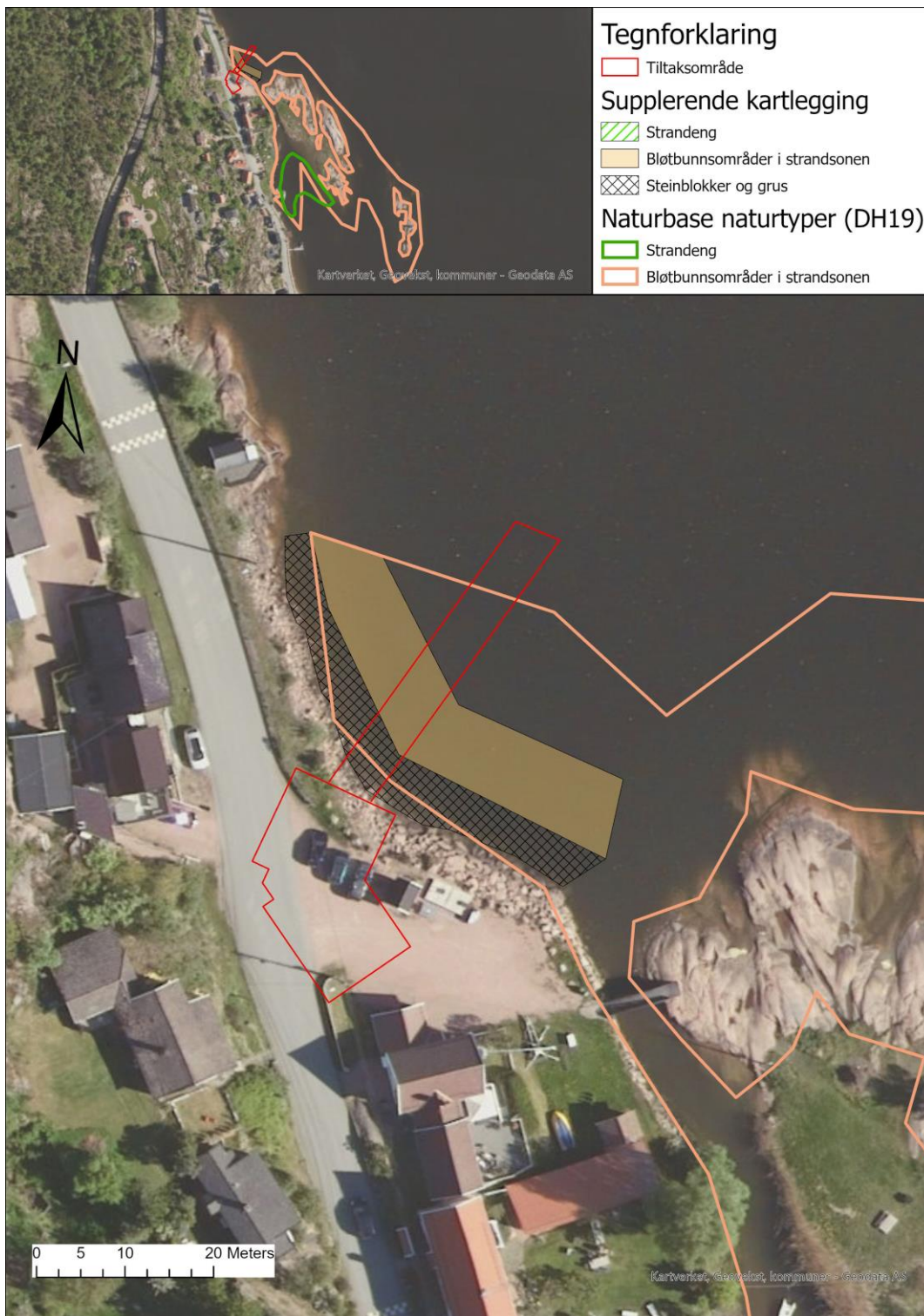
Figur 4-10: Illustrasjonskart over tiltaksområdet ved Blindeskjæra, samt registrerte naturtyper i Naturbase og oppdatert arealutbredelse for naturtypen bløtbunn i strandsonen basert på supplerende kartlegging. Supplerende kartlegging viste at naturtypelokaliteten er begrenset til et belte langs land mellom dybde 1-2 m, og at arealutbredelsen i Naturbase er noe unøyaktig. Målestokk: 1:500 (oversiktskart 1:5000).
