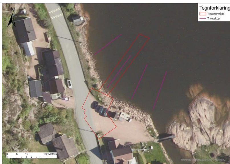
Figur 4-4 : Oversiktskart over tiltaks- og influensområdet ved Blindeskjæra. Transektene for kartleggingen er vist ved lilla streker og lengden på transektene ble avsluttet ved 5 m dybde. Målestokk: 1:400
