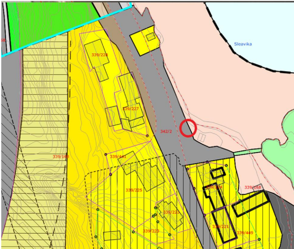
Figur 4 - Utsnitt av gjeldende reguleringsplan. Rød sirkel viser plassering av overbygd vannkum ved Blindeskjæra
