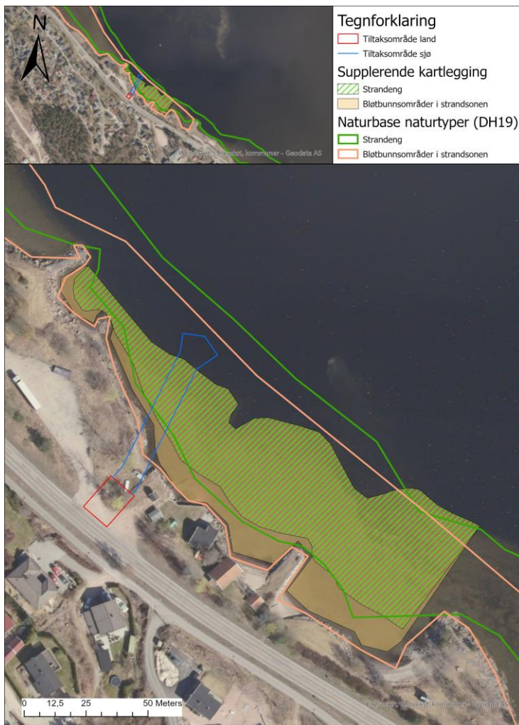
Figur 4-5: Illustrasjonskart over tiltaksområdet ved Tangen, samt registrerte naturtyper i Naturbase og oppdatert arealutbredelse for naturtypene basert på supplerende kartlegging. Supplerende kartlegging viste at undervannsenga følger ca. dybdekote -2 m og at arealutbredelsen i Naturbase er noe unøyaktig. Naturtypen bløtbunn i strandsonen avgrenses generelt til dybdekote -2 m og vi har derfor korrigert avgrensningen av også denne naturtypen basert på dybdemålinger i felt. Målestokk: 1:1000 (oversiktskart 1:5000).
