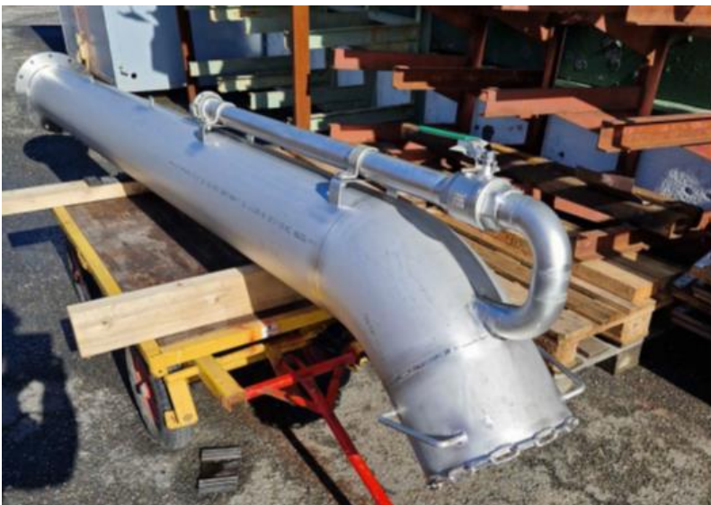
Figur 2-1: Eksempelbilde av en håndholdt ejektor som er planlagt å benytte.
