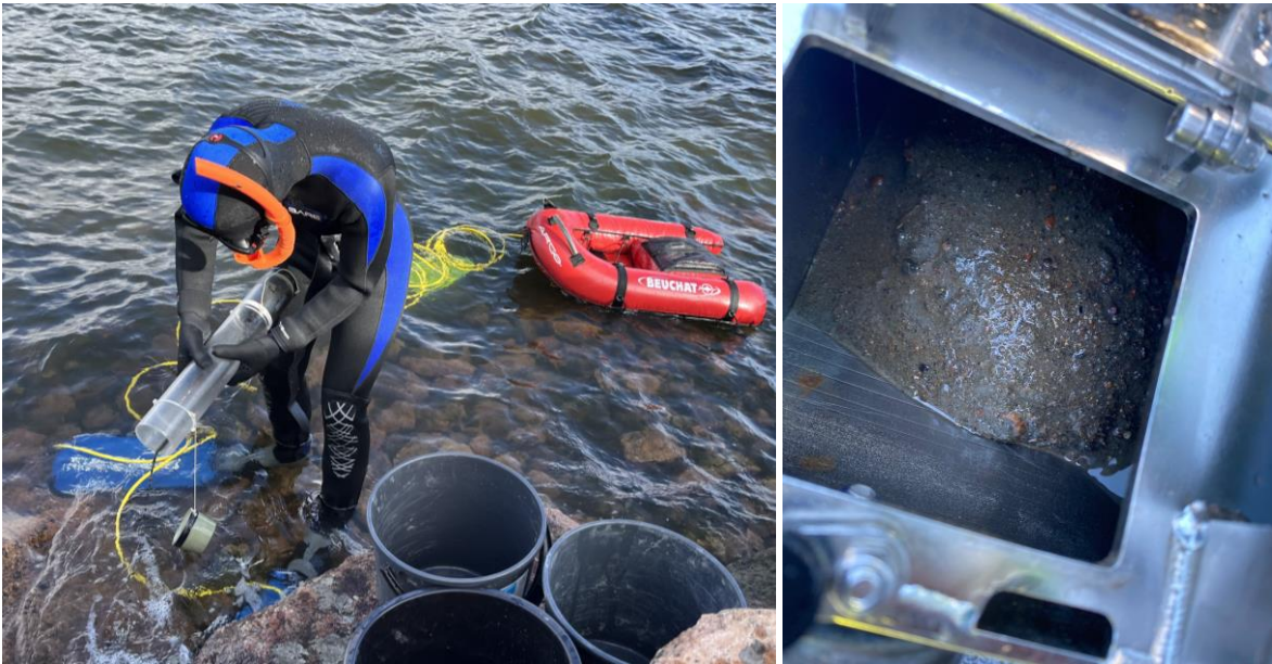
Figur 5-2 : Illustrasjonsbilde av sedimentprøvetaking med håndholdt kjerneprøvetaker (t.v). Foto: Lorentz Reinertsen/Sweco. Illustrasjonsbilde av sedimentprøve tatt med håndholdt grabb fra båt ved stasjon S2 (t.h). Foto: Sofie Myhre Kvaløy/Sweco
