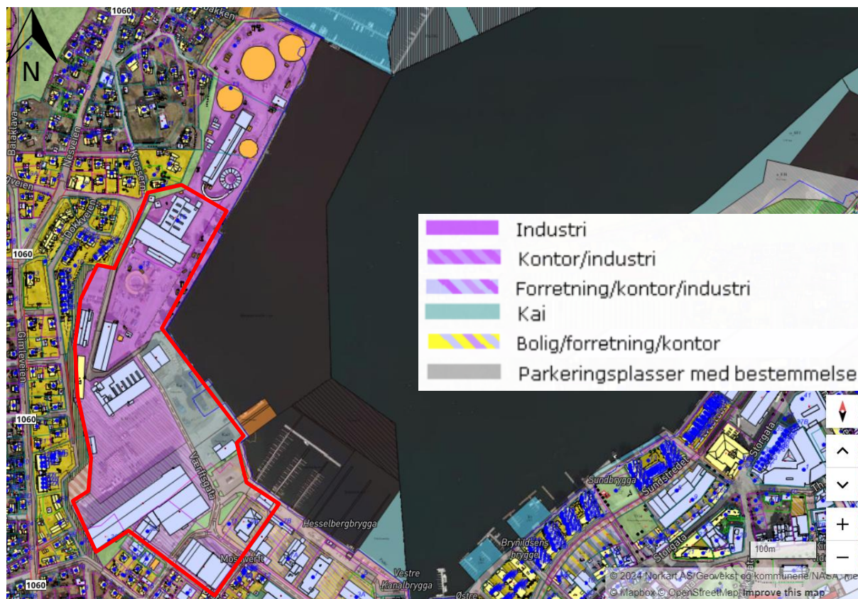
Figur 2. Kartutsnitt viser beliggenheten til tiltaksområdet i Moss kommune. Tiltaksområdet er markert med rød omriss. Nøyaktig plassering av områdene som blir påvirket av gravearbeidet (kabeltraseene) er vist i Figur 3. Gravearbeidet vil foregå i områder med ulikt reguleringsformål. Reguleringsformålet vil påvirke akseptkriteriene for akseptabel forurensningsgrad i grunnen. Kartet er hentet fra Moss kommunekart.
