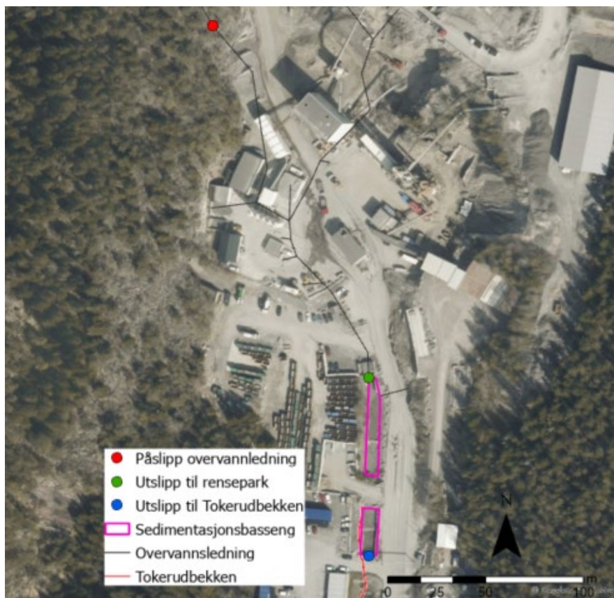
Figur 6: Viser plassering av påslippspunkt fra FRANO til overvannsnettet på Bondkall, påslippspunktet fra overvannsnettet til sedimentasjonsbassengene og utslippspunktet til Tokerudbekken.
