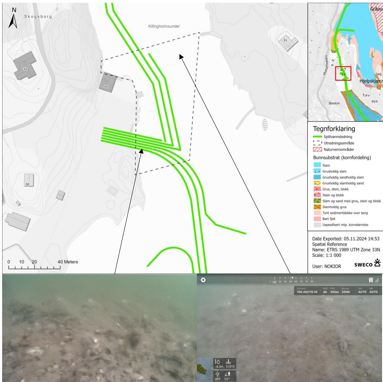
Figur 6.4: Illustrasjonskart av landtaket ved Skogsborg som viser 1) omtrentlig plassering av VA trasé, 2) oversiktskart med bunnsbstrat hentet fra marine grunnkart (mangler data i selve landtaket), 3) område kartlagt med ROV og 4) representative bilder av sjøbunnen hentet fra ROV-video (bløtbunn med mye tomme skjell, inkl. blåskjell og stillehavsøsters).
