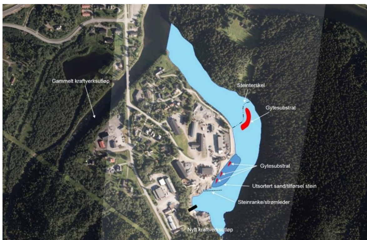
Figur 3. Prinsippskisse for arbeidet knyttet til tiltaksområdet mellom nytt og gammelt kraftverksutløp i Røssåga. Spredt utlegg av steinblokk nedstrøms steinterskel er ikke tegnet inn. Skissen er hentet fra Kanstad-Hanssen et al. (2015).
