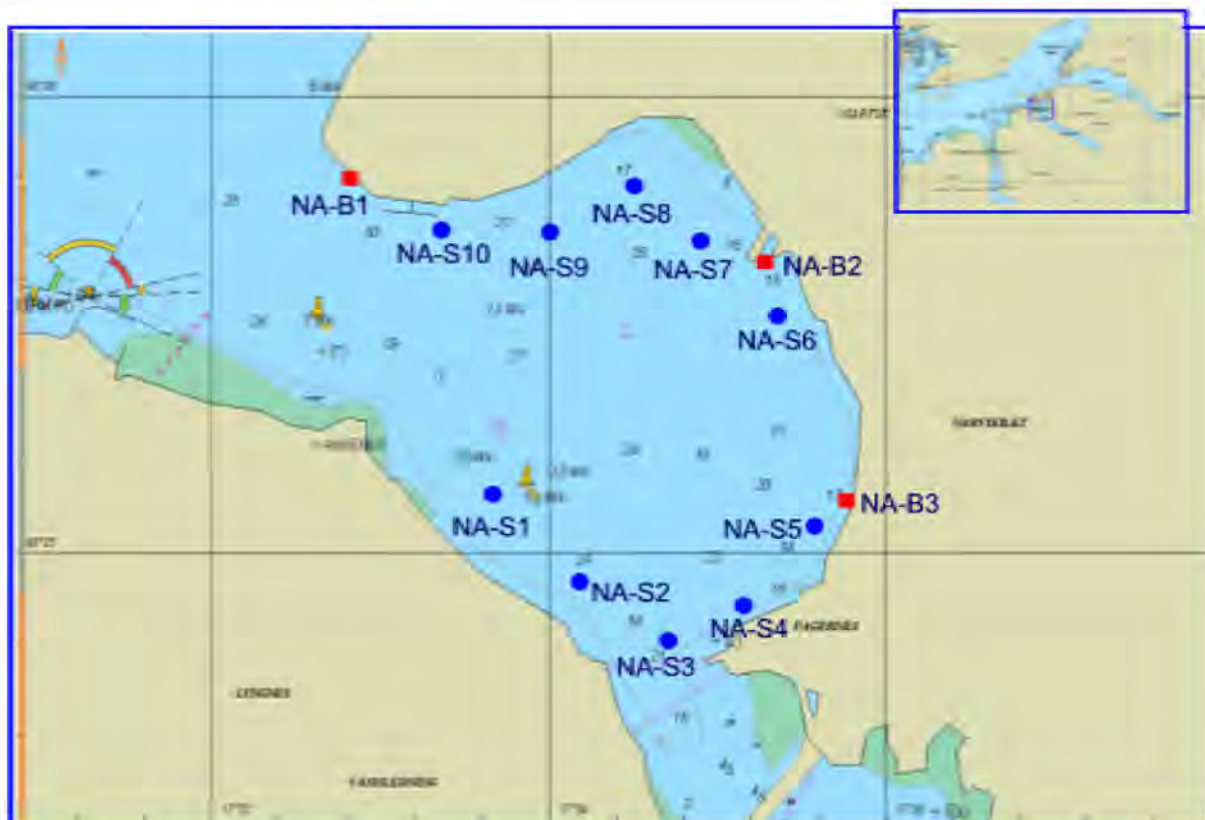
Figur 4-9 Prøvetakingspunkter for sedimenter (NA-S) og o-skjell (NA-B) i Narvik oktober 2001. Kartet er digitalisert av DNV på bakgrunn av Sjøkartverkets havnekart. Prøvetakingspunktene er plassert manuelt på kartet og kan derfor avvike noe fra virkelig posisjon (<20 m).
