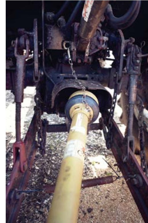
Kraftoverføringsaksel skal ha vern. Foto: Kolbjørn Taklo
