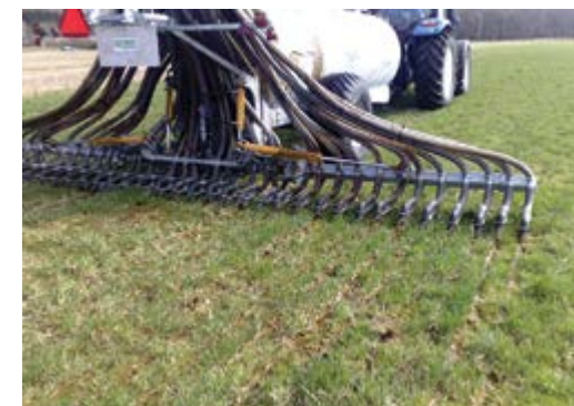
Grunn nedfelling gir mindre tilgrising og stor nøyaktighet. Foto: Sverre Heggset.
