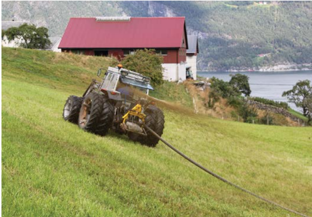
Hjå Straumsnes Mjølkk og Kjøtt sver dei til bladspreiaren som er lett, spreier breidt og som er enkel å køyre. Foto: Sverre Heggset.
