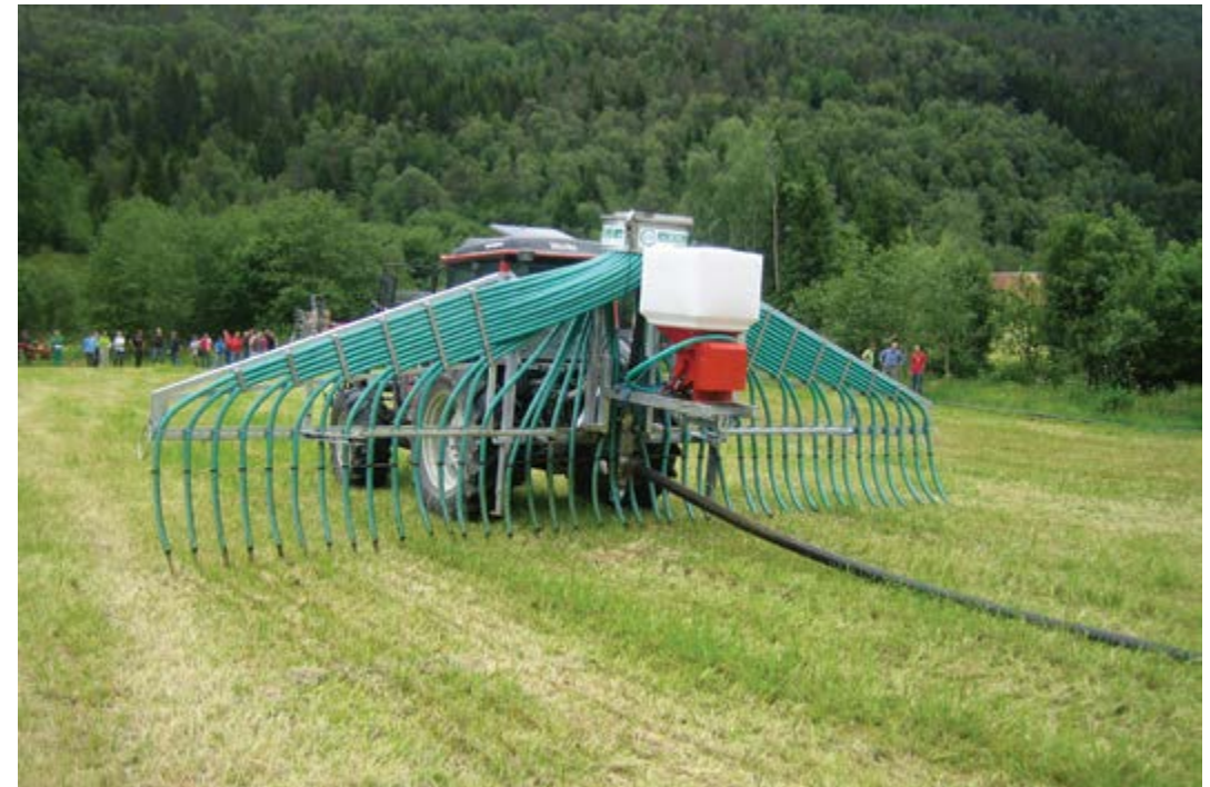
Stripespreiing og bruk av slepeslange er ein god måte å spreia husdyrgjødsel på. Kan utførast med traktor av moderat storleik, god hjulrusting med lågt luftrykk, og medfører moderat jordpakking. Foto: Dag Arne Eide, NLR.
