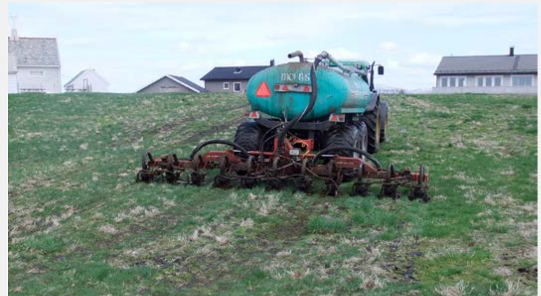
DGI-metoden minskar lukt og tap av ammoniakk til luft. Foto: Olav Martin Synnes
