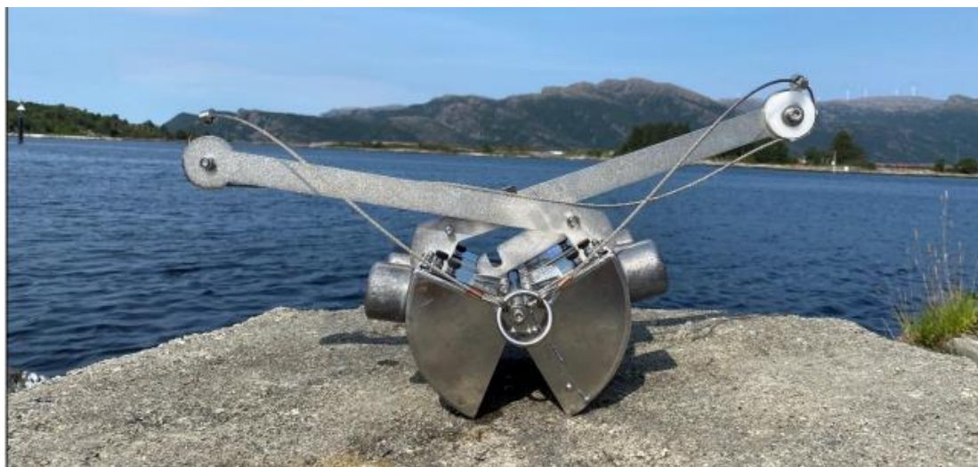
Figur 3: Van veen grabb (illustrasjonsbilde) egnet for prøvetaking av sediment.
