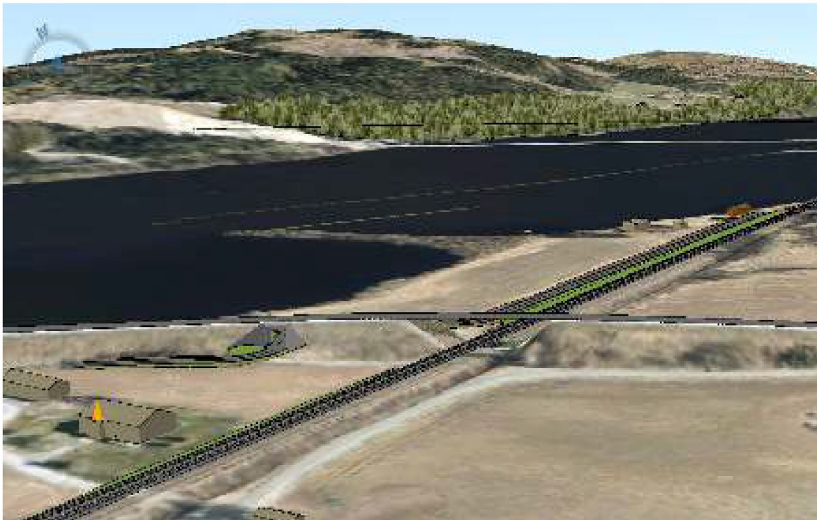
Figur 4.1 Utsnitt fra 3D- modellen. Utsnittet viser nytt spor, ny kulvert under Kraftverksvegen og ny driftsveg nord for nytt kryssingsspor (grusveg).
