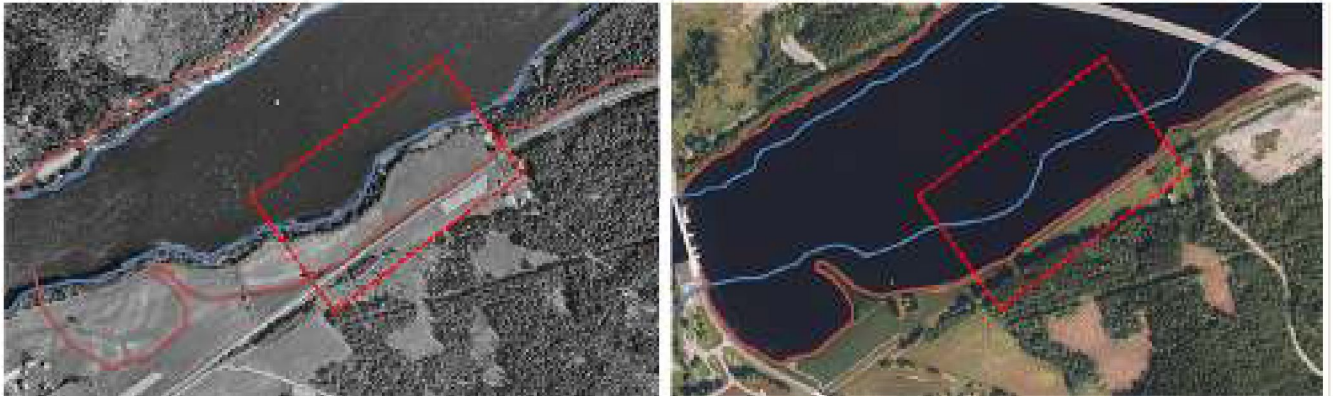
Figur 4.10 Utklipp fra historiske kart datert 1973 (bilde til venstre) og 2016 (bilde til høyre). Blå strek indikerer kanten av Glomma før etablering av Kongsvinger kraftverk. Rød strek indikerer kanten av Glomma etter etablering av kraftverket.
