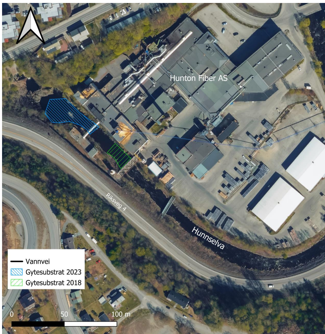
Figur 25: Kart over Hunnselva nedstrøms Brufoss kraftverk. På nordsiden av elva ligger Hunton Fiber AS og på sørsiden går riksveg 4. Omtrent 100 tonn med gytesubstrat ble fordelt på et areal tilsvarende 235 m 2 i 2018 (grønt område). I 2023 ble det observert grus på omtrent 600 m 2 (blått område). Kilde: Kartverket.
