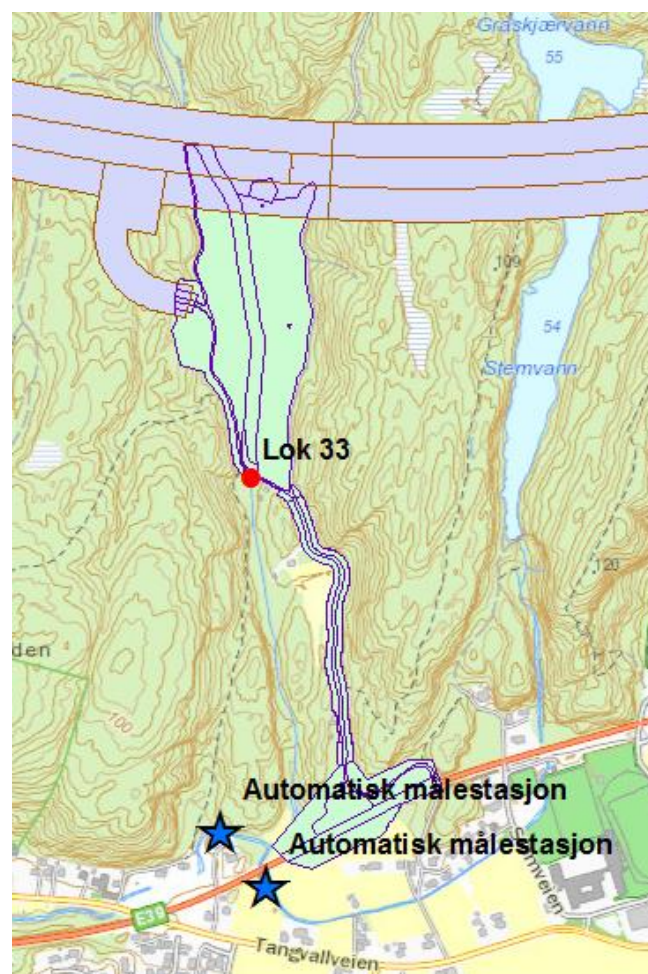
Figur 18: Delområde 5 – Overvåking i anleggsfasen. Regulert areal jfr. reguleringsplanen er inntegnet. Bekken fra Hellersdalen skal overvåkes i Lok 33. I tillegg skal det etableres automatiske målestasjoner i Føssa (markert med blå stjerne) før og etter samløp med bekken fra Hellersdalen.
