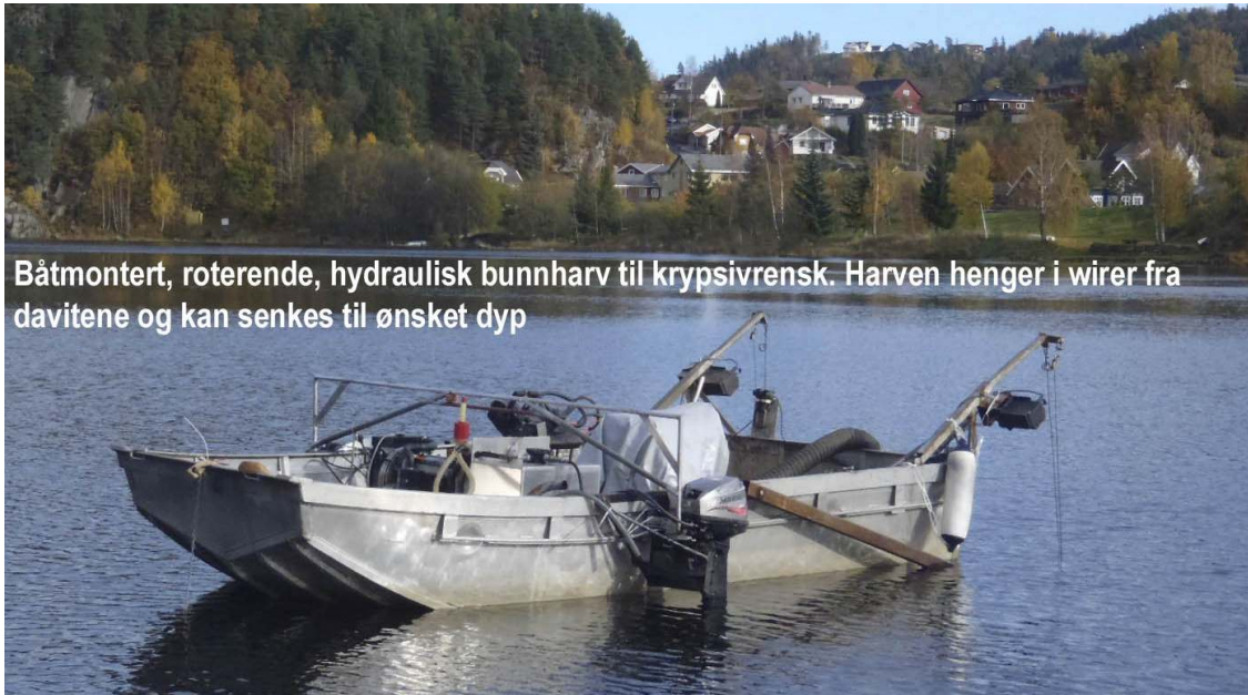
Kilefjorden 3. september 2014; Roterende hydraulisk harv fra Amfibjeservice as rensker krypsiv ved Kilefjorden camping.
