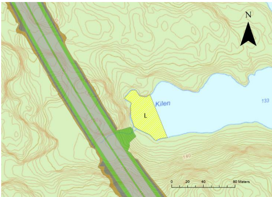
Figur 9: Oversikt over forurensningssituasjonen for sedimenter, område 2. Fargelagt etter tilstandsklasser i Veileder M608, gult område er tilstandsklasse 3.
