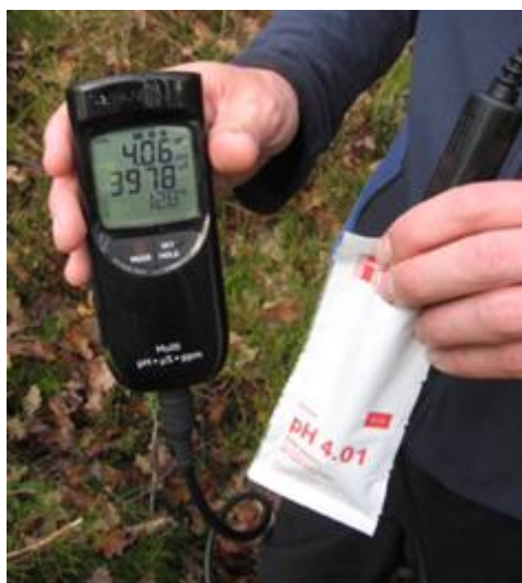
Figur 0-7. Multiparametersonde benyttet for å måle temperatur, pH og konduktivitet in-situ. Foto: Sweco.
