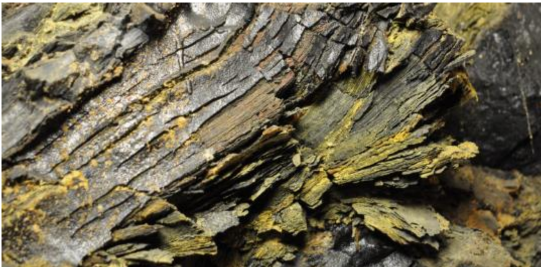
Figur 1 Alunskifer som forvittrer ved tilgang på fuktig luft vil svulle til et volum som kan være 2-3 ganger opprinnelig volum (høyden på bildeutsnittet er ca. 5 centimeter). Gule utfellinger er Fe_2(SO_4)_2 mineraler (jarositt eller kopiatitt).
