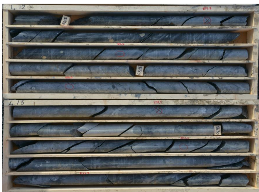
Figur 8 Kjerneprøver fra kjerneboring. Øverste fire kjerner er Galgebergskifer (3b6) og nederste seks kjerner er Hukskifer (3c).
