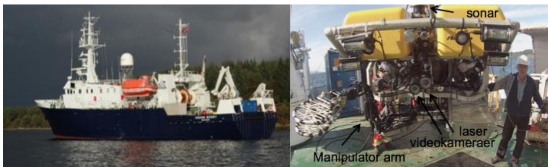
Figur 3. Forskningsfartøyet Håkon Mosby og den fjernstyrte undervannsfarkosten Aglantha ble brukt til kartleggingen av dyrelivet ved den vertikale fjellveggen på Huglo i Juni 2016.
