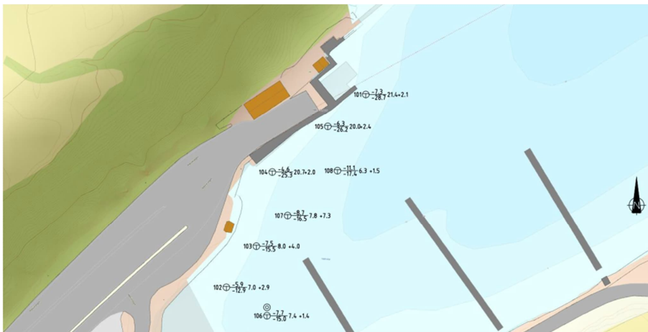
Figur 5-3: Borplan fra geoteknisk grunnundersøkelse [2].
