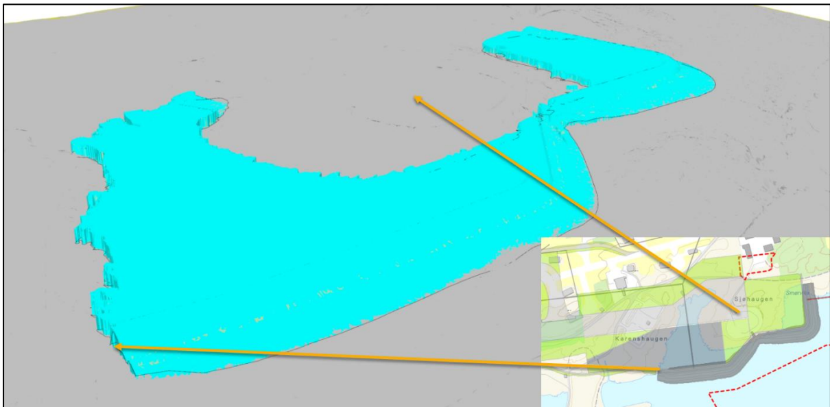
Figur 13: Sjøbunnsareal berørt av utfyllingen hentet fra Gemini, areal for nedfylte bergknauser er ikke inkludert i arealet sjøbunn som fylles ut. Kilde: COWI.
