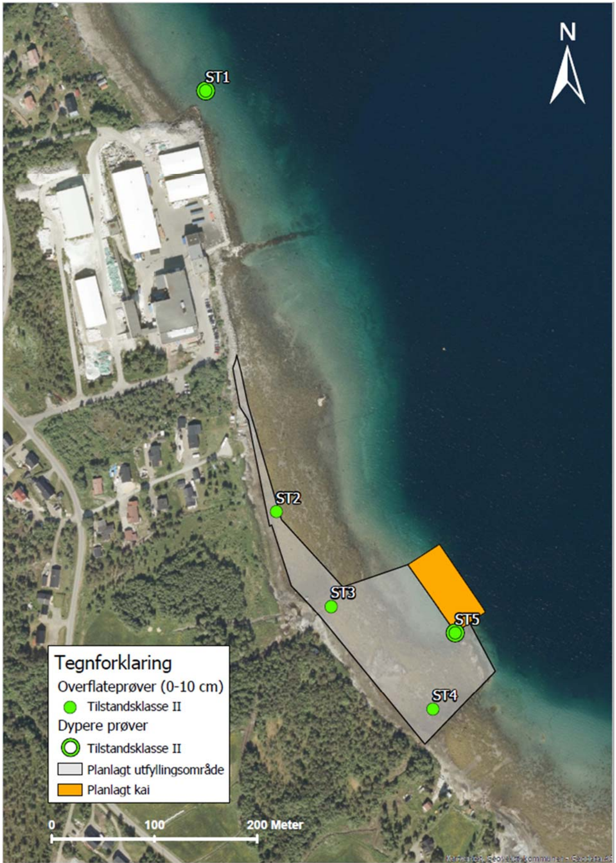
Figur 4-2: Undersøkt område. Prøvestasjoner for overflatesediment (0-10 cm) og dypere prøver (40-50 cm) er markert med fargesymbol for høyeste påviste tilstandsklasse.
