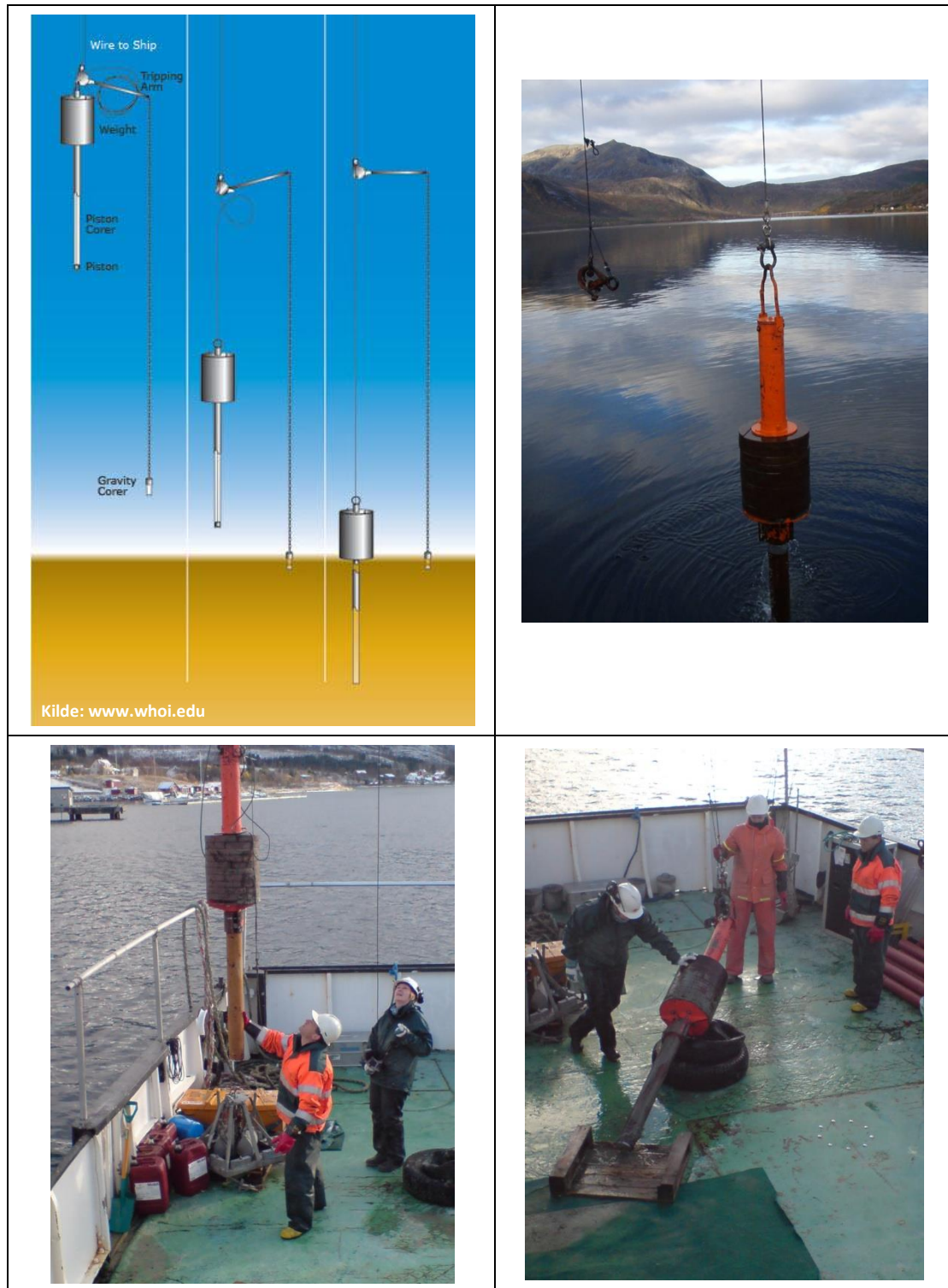
Figur 2-3: Prinsippskisse for prøvetaking med «Gravity Corer», samt Multiconsults «Gravity Corer» i bruk.
