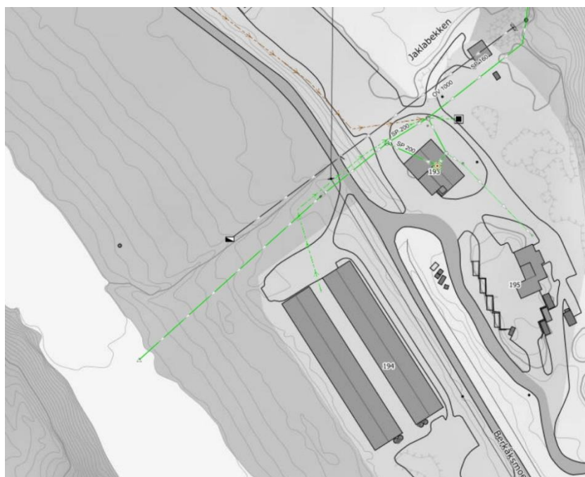
Figur 13: Utslippsledning med utslipp til Orkla.
