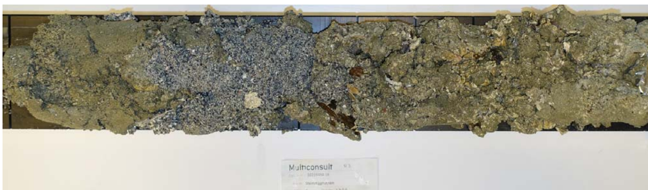
Figur 4-2: Grusig sand fra 6-23, dybde 1,2-2,0 m. Høyt innhold av korall og skjellrester.
