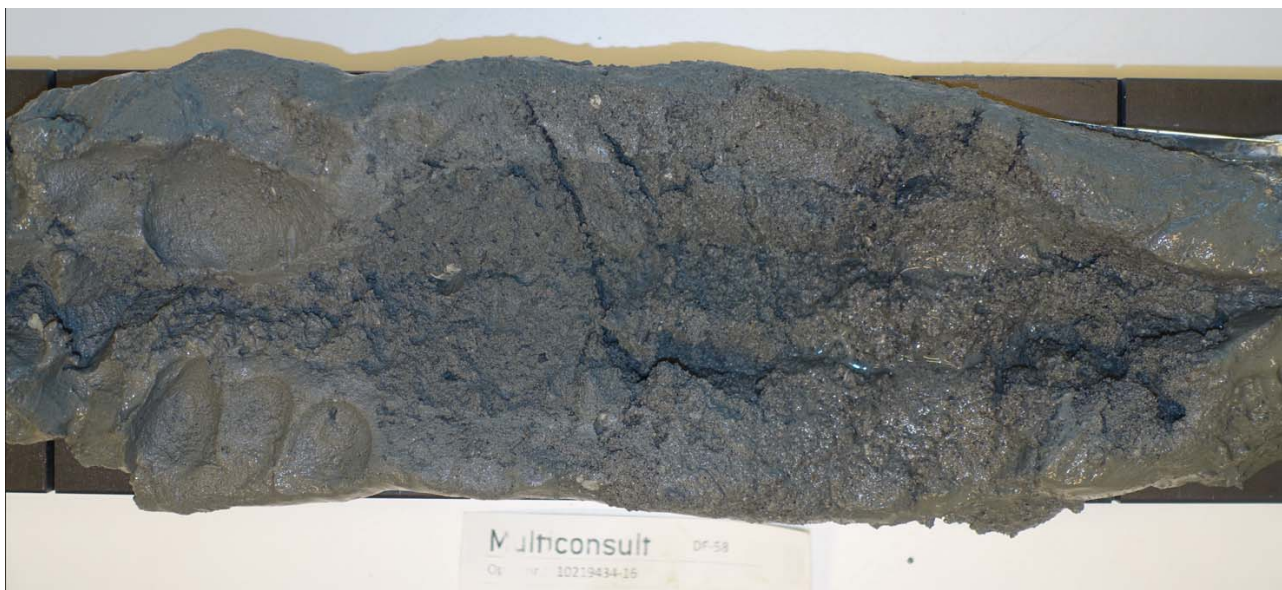
Figur 4-3: Cylinderprøve fra 17-23, dybde 1,7-2,1 m. Siltig, leirig sand. Det er enkelte skjellrester i prøven.
