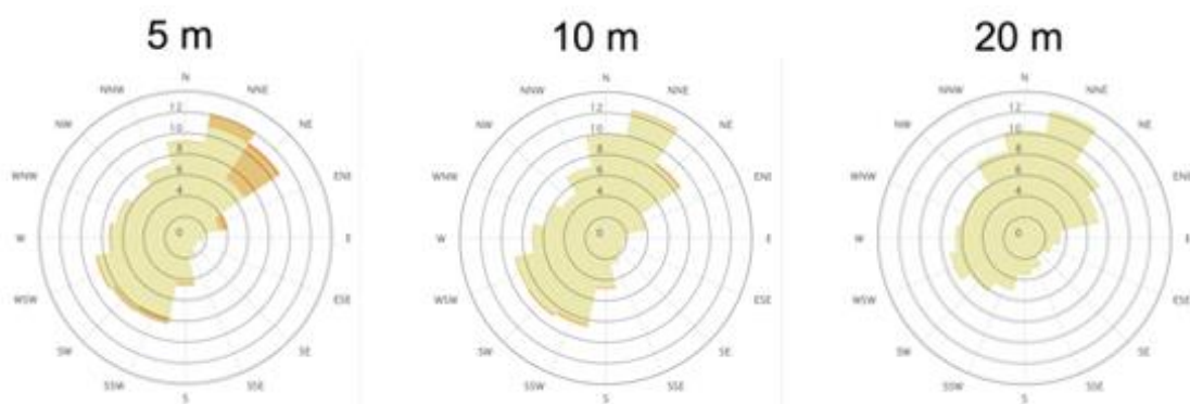
Figur 3-3: Strømroser med modellerte strømretninger fra området der tiltaksområdet befinner seg. Modellopløsning: 800 m. Informasjon og figurer hentet fra Strømkatalogen, Havforskningsinstituttet (09/08/2022).
