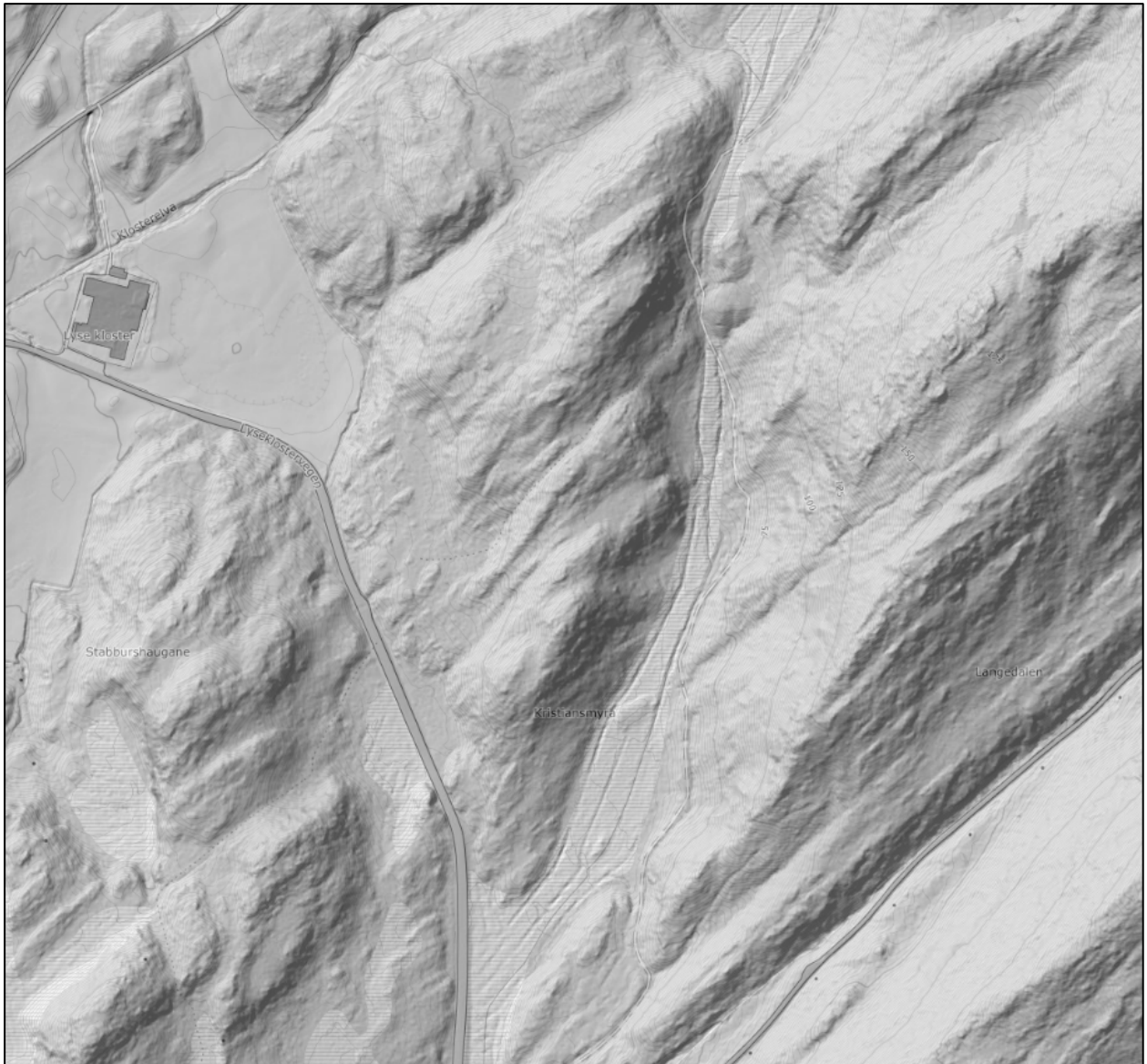
Figur 16: Digital terrengmodell (DTM) av området som tydeleg syner grøfting av myra. Kjelde: Kartverket/Høydedata.no
