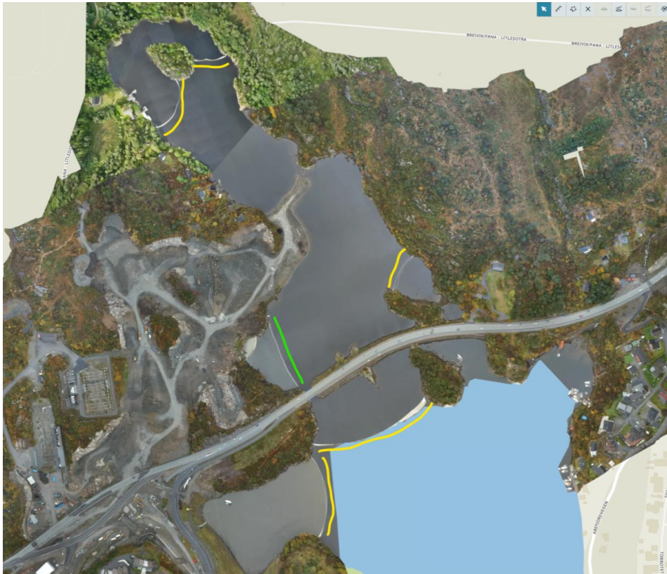
Figur 2 Planlagte siltgardiner i Arefjordpollen. De gule viser der det skal etableres doble siltgardiner. Den grønne viser siltgardiner i reserve. (Kilde SL CJV)
