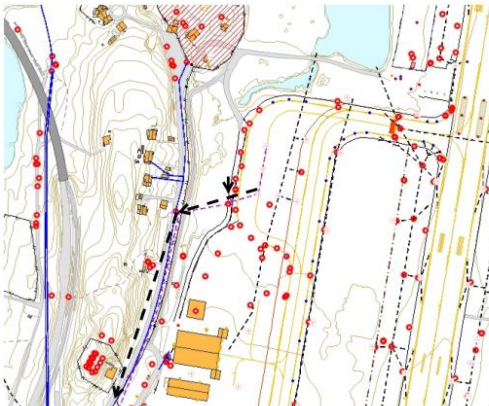
Figur 3 - Avrenning og ledningsanlegg flyavising nord.
