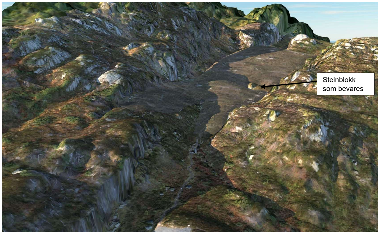
Figur 2-8: Illustrasjon av ferdig arrondert tunnelmassefylling, sett fra sør mot nord. Ny landingsplass for helikopter ved søndre tunnelpåhugg, fremkommer ikke på illustrasjonen. Den bevarte steinblokken sees i høyre kant av deponiet.
