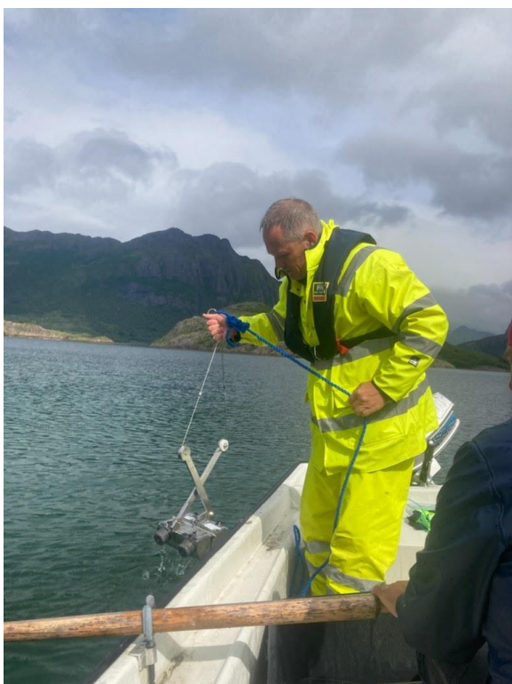
Figur 2. Prøvetaking fra båt med Van Veen-grabb.
