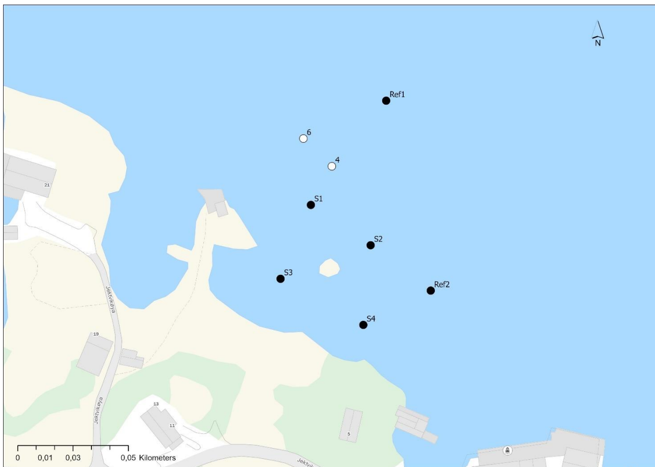
Figur 7. Oversiktskart (1:1000) med prøvepunkter. Grønne punkter er tatt med Van Veen grabb, oransje punkter er sylindrerprøver fra borepunkter.
