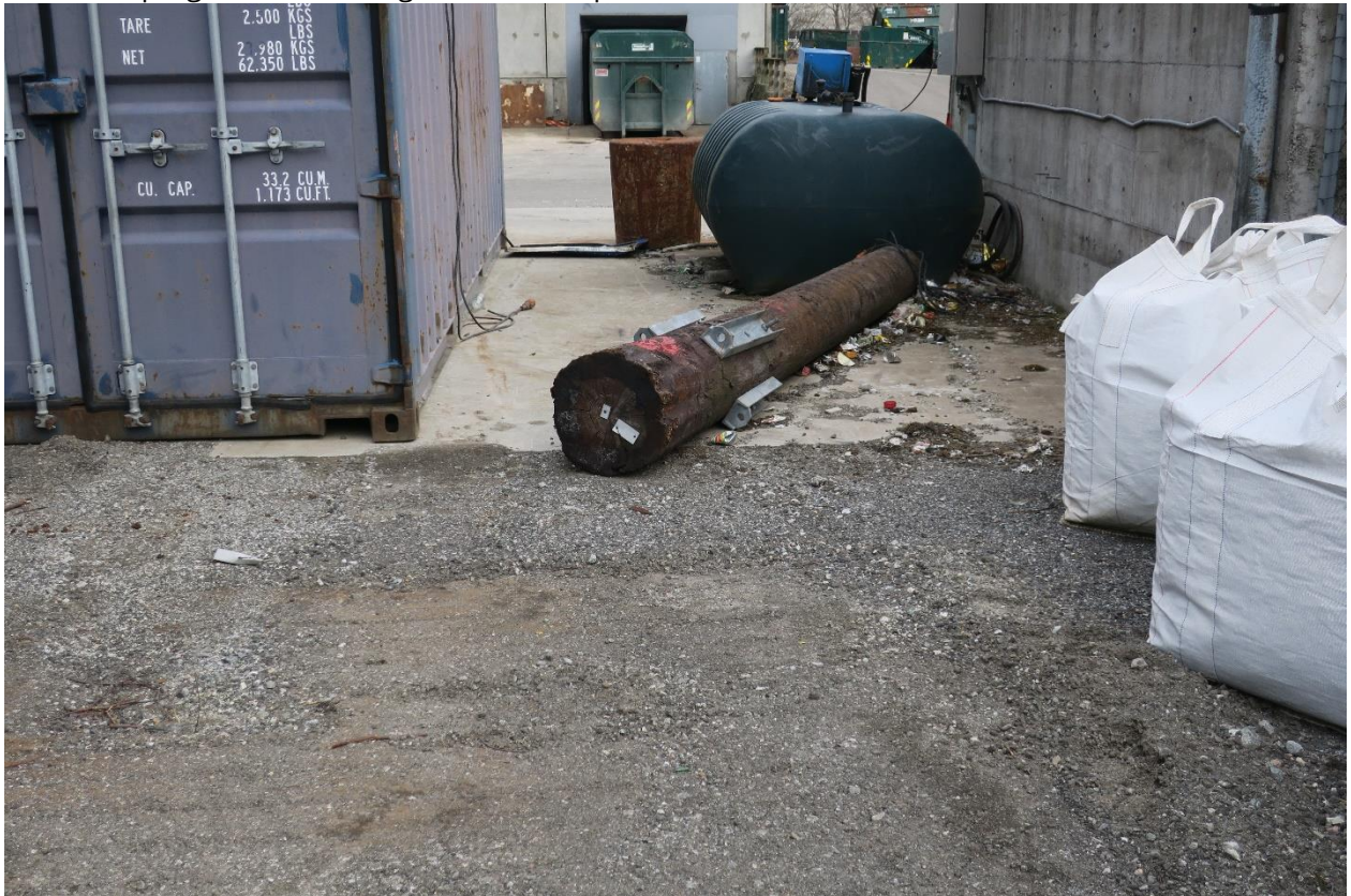
Kreosotimpregnert trevirke lagret ute delvis på utett dekke:
