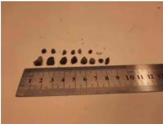
Fjernet gruskorn fra prøven før konusforsøk
