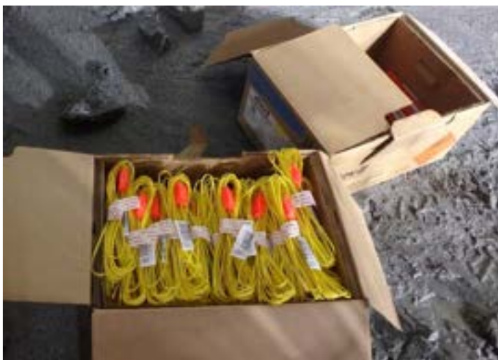
Figur 2: Elektroniske tennere – rød koblingsboks, gul skyteledning (metalltråd kledd med plast) og hvit «tag» med Id-nr på hver enkelt tenner.
