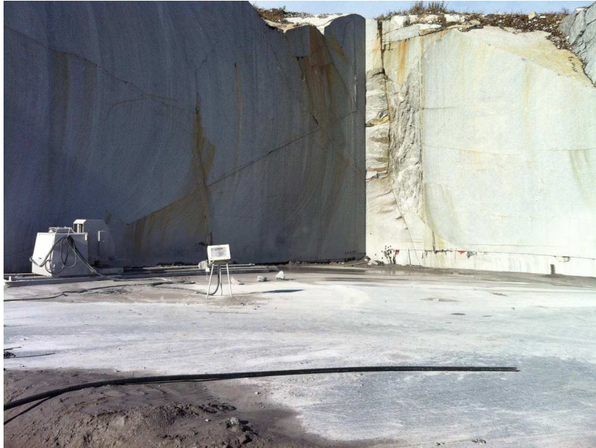
Figur 3.2c Wiresaging av horisontalt kutt
