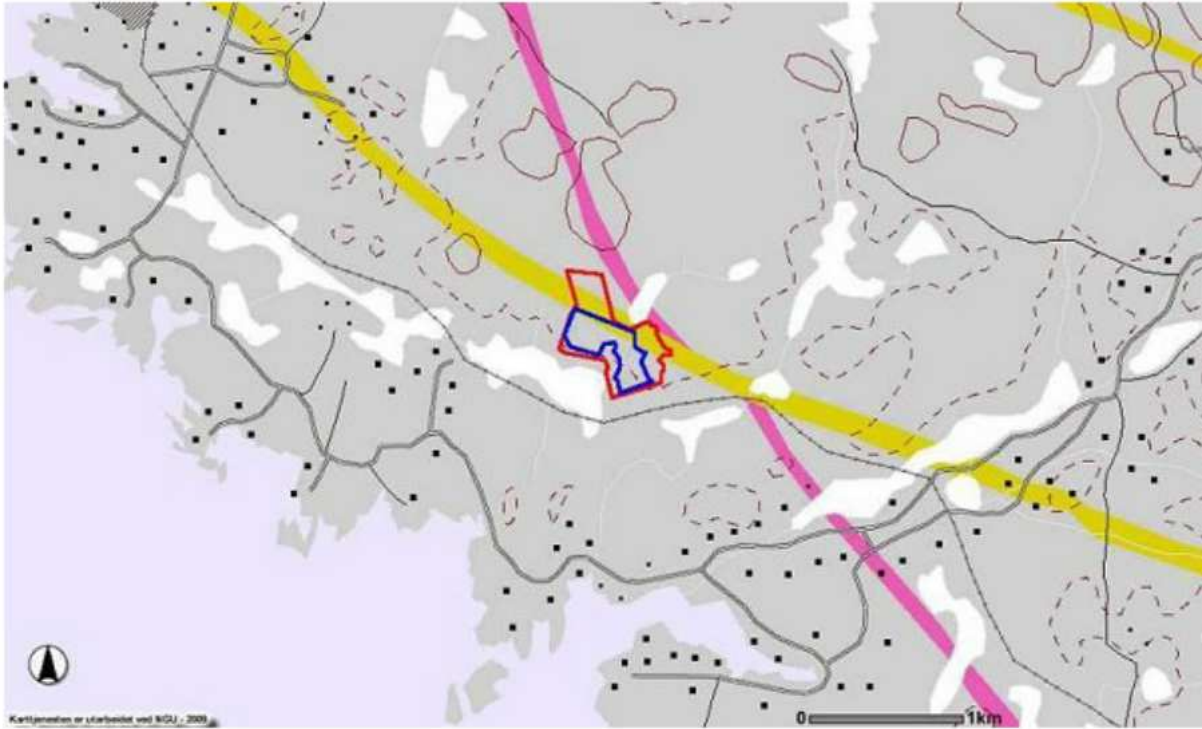
Figur 2.9 Utsnitt av berggrunnskart for området rundt tiltaksområdet. Lys grå er anortositt, gul er diabas og rosa er monzonitt. (Kartgrunn-lag: NGU)
