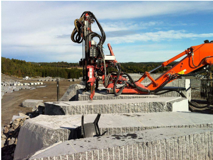
Figur 3.2f Formatering av emner fra flak til ferdig blokk og kvalitetskontroll av ferdig blokk
