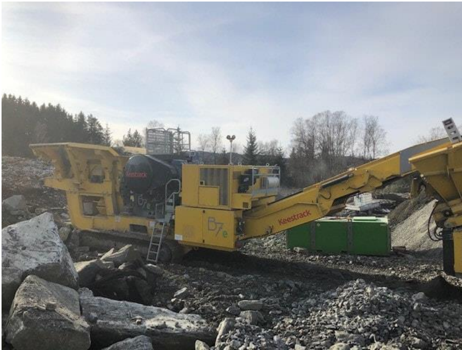
Figur 2 Eksempel på grovknuser, Keestrack B7e. (Foto: Romarheim AS).
