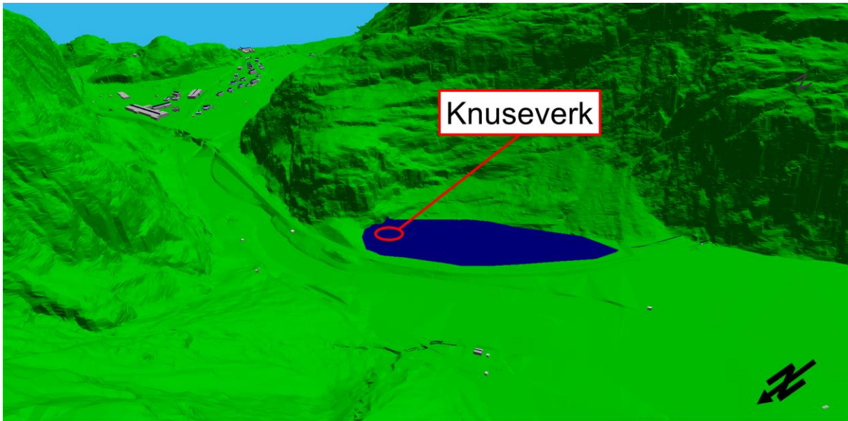
Figur 4 Utdrag av 3D-visning fra støyberegningmodell, Dalehagen. Støyende aktivitet på anleggsområdet er skissert med mørk blå farge. Plassering av knuseverk som er lagt til grunn i beregningene er vist med rød ring.
