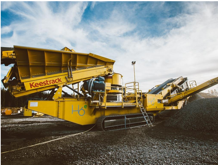
Figur 3 Eksempel på finknuser, Keestrack H6e. (Foto: Fredheim maskin AS)
